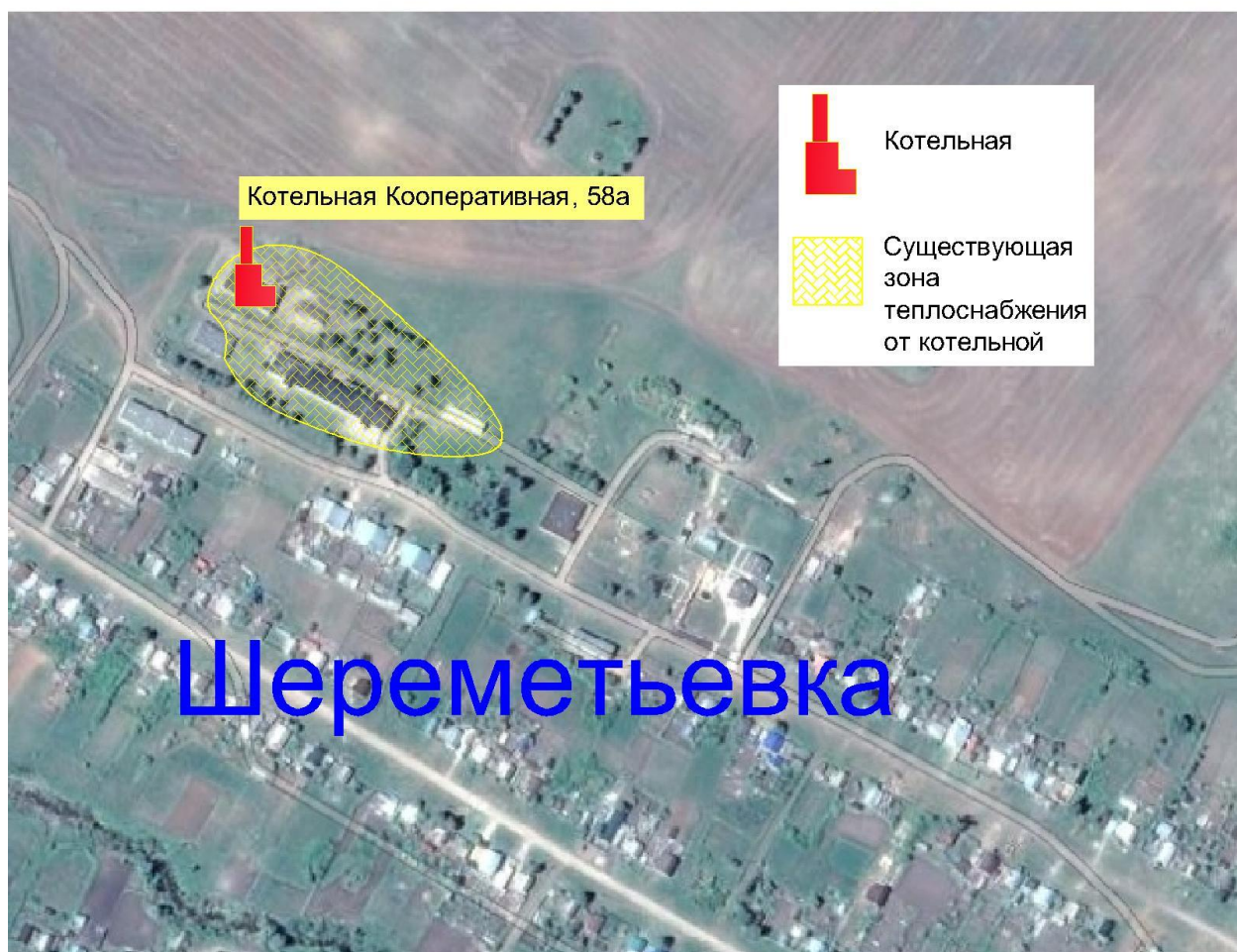
Рисунок 1-3. Существующая зона теплоснабжения котельной больницы
