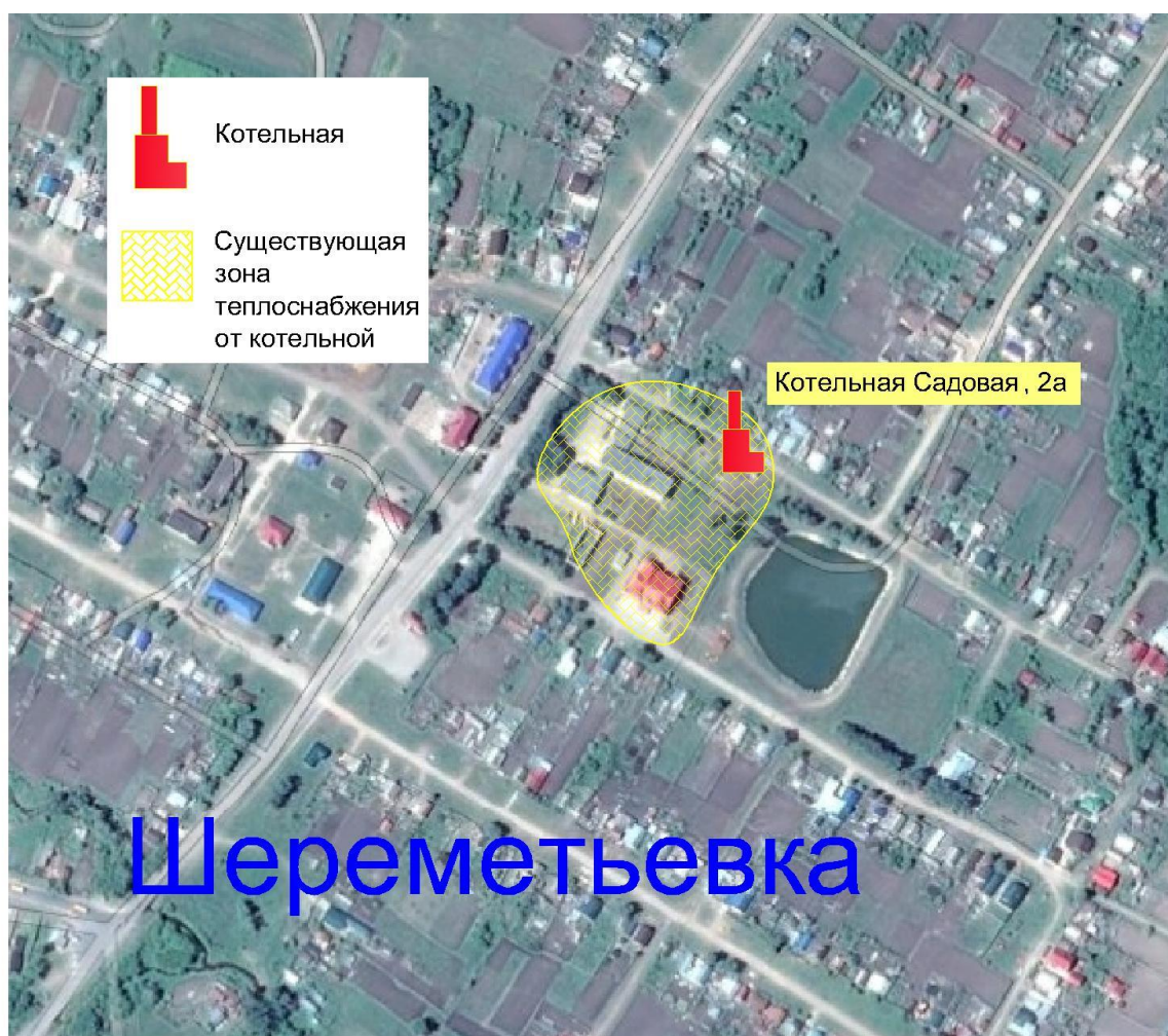
Рисунок 1-4. Существующая зона теплоснабжения котельной школы
